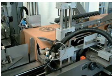
Kartonverschlussstation mit Heißleim.
