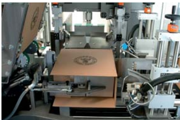
Der Karton ist aufgerichtet und wird anschließend durch das Mundstück befüllt.
