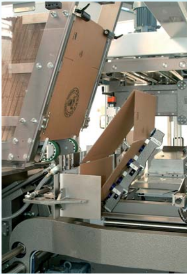
Einfache und sichere Kartonaufrichtung durch Vakuumsauger.
