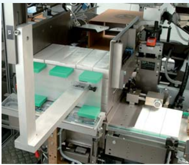
Stapel- und Einschubstation.
