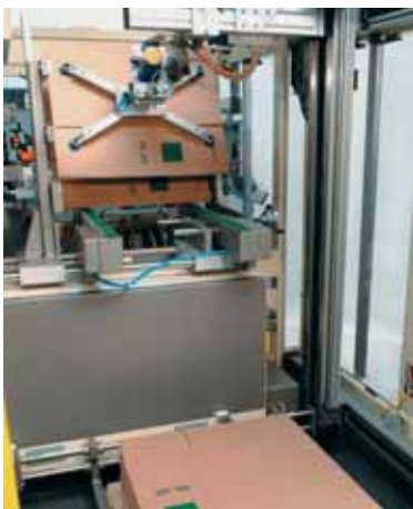
Einlegen des Zuschnitts in das Kartonmagazin
