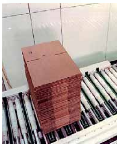
Rollenbahn mit Zuschnittstapel
